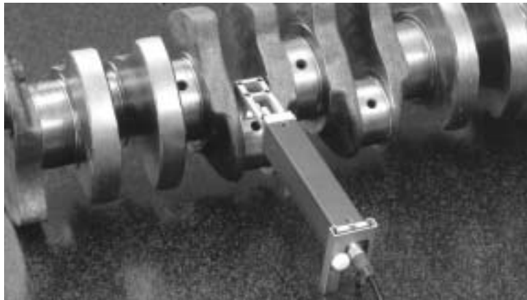
Medición transversal (recta) de un muñon del cigüeñal
