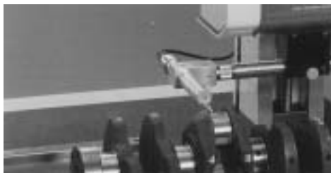
Medición del eje con palpador largo
