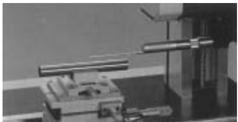
Medición de la dirección de radio con unidad rotatoria
