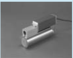
Medición de cilindro con un pie de soporte
