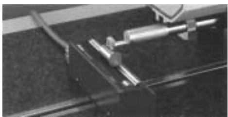
Medición de la dirección de radio con unidad rotatoria
