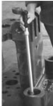
Este verificador de inserción se ha diseñado exclusivamente para la medición de diámetros interiores.
