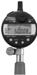
Retiene el valor mínimo para medir fácilmente diámetros de barrenos.
